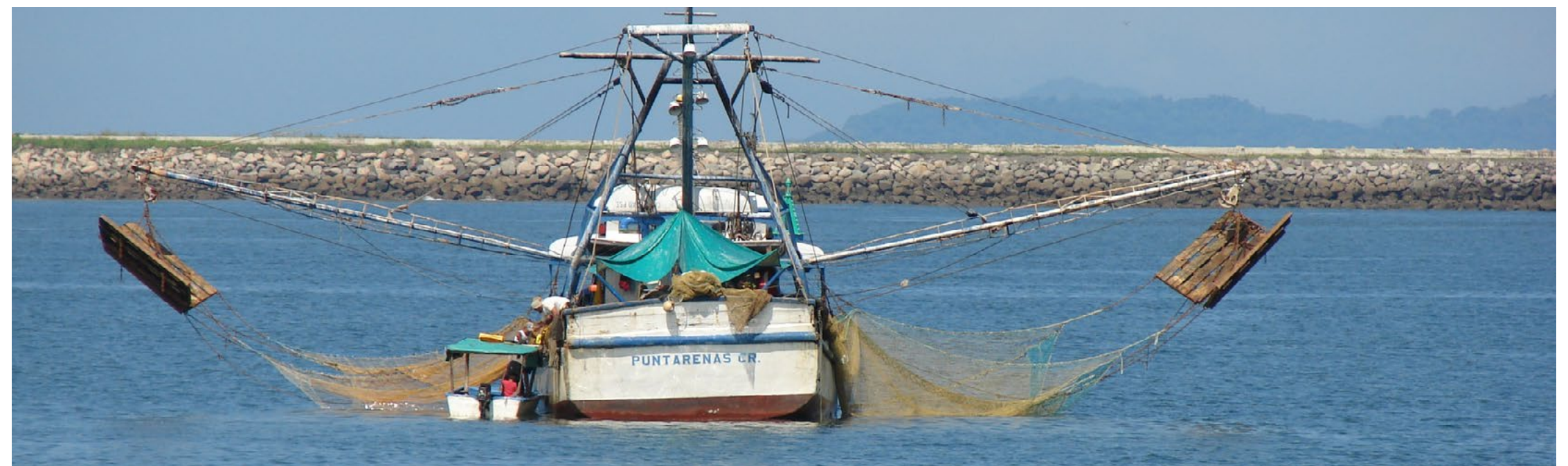
Figura 43. Barco camaroneo tipo Florida, usado por la flota de arrastre en Costa Rica (José Miguel Carvajal / MarViva)
